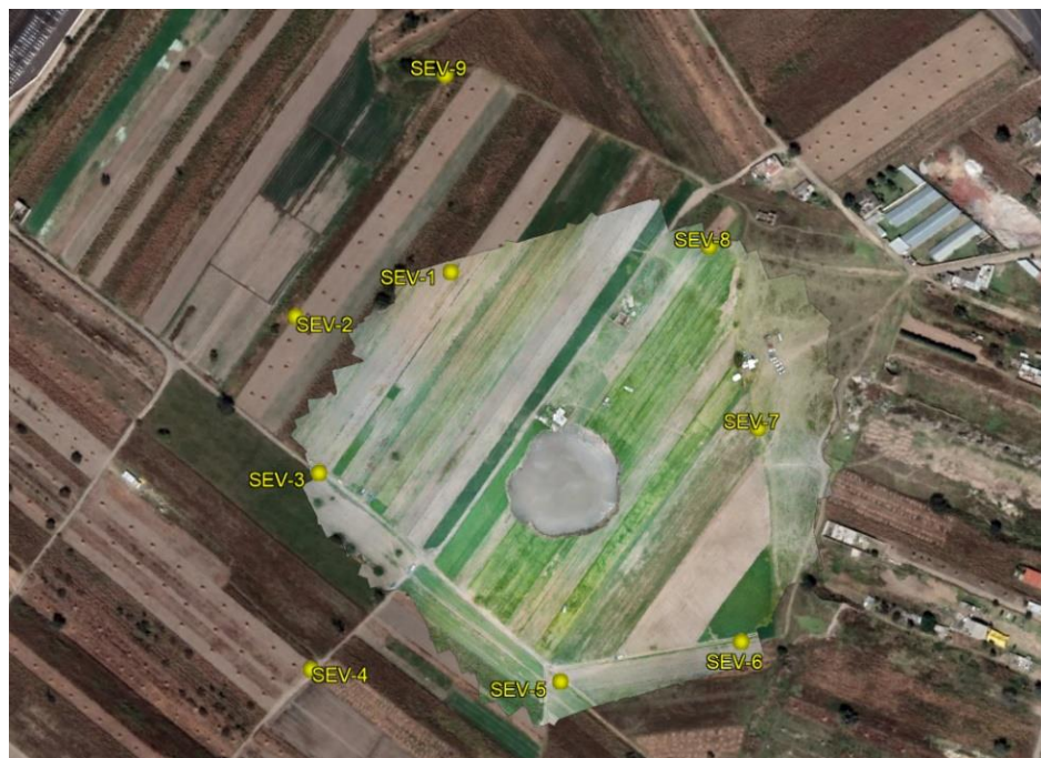
Fig. 4 Arreglo radial de los SEVs.
